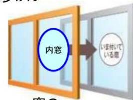
窓の断熱改修工事
